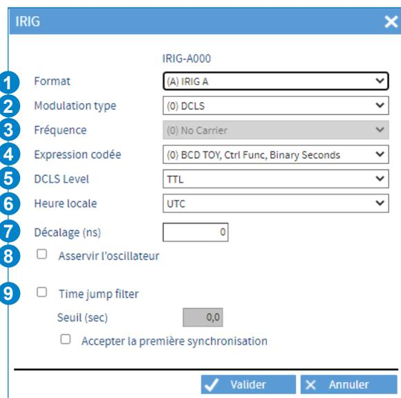
1) Choix du format d'entrée suivant la source du signal : IRIG A/B/E/G, AFNOR 87500. Les formats IRIG se caractérisent par des fréquences d'impulsion différentes.
