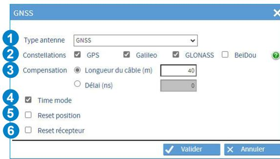
1) Choix du type d'antenne : GNSS ou Secure GNSS (résistant aux tentatives de brouillage et de leurrage). Si l'antenne Secure GNSS est choisie, une option permettant d'exclure la synchronisation GNSS en cas de détection de leurrage est proposée. Dans ce cas, le serveur utilisera automatiquement une autre source de synchronisation.
