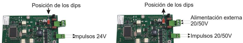
El jumper permite parametrizar la potencia de salida de esta línea.
