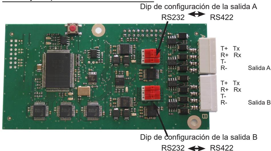
Esta tarjeta opcional posee dos salidas ASCII que se pueden configurar por RS232 o RS422 (RS485). Para cambiar de configuración, ponga los tres dips en la posición deseada.
