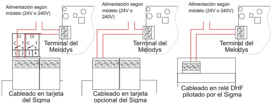
El Melodys se puede conectar directamente en una de las salidas relé del Sigma, en una tarjeta opcional o en un relé DHF.
