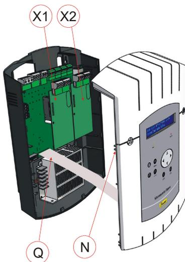
**Versión BASTIDOR:** Abra el cajetín bastidor e instale la/s tarjeta/s opcionales en las ubicaciones previstas (X1) y (X2).
