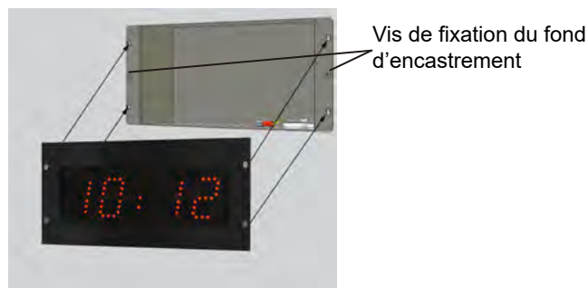
Intallation avec fond d'encastrement
