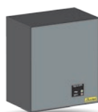
SIGMA UPS mural Alimentation secourue. Batterie 5 Ah - 24 V DC avec chargeur. Montage mural - 8 kg. 290 x 220 x 130 mm.
