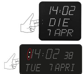
Beispiel einer Style 7D beim gleichzeitigen Drücken beider Tasten:
