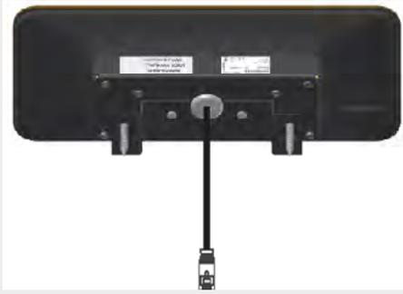
Das ca. 1.80 Meter lange Kabel ist mit einem RJ45-Stecker mitgeliefert. Mit den wasserdichten Modellen, zuerst dieser RJ45-Stecker entfernen; dann das Kabel durchtrennen; die Leitung durch die Kabeleinführung ziehen und einen neuen RJ-Stecker im Inneren des Gehäuses zu crimpen.
