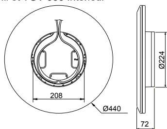
Profil et TGV 930 avec disque de verrouillage
